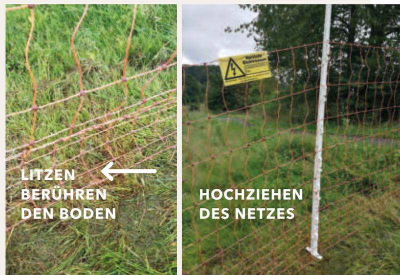
Abb. 109: Lösung gegen durchhängende Netze und Spannungsverluste
