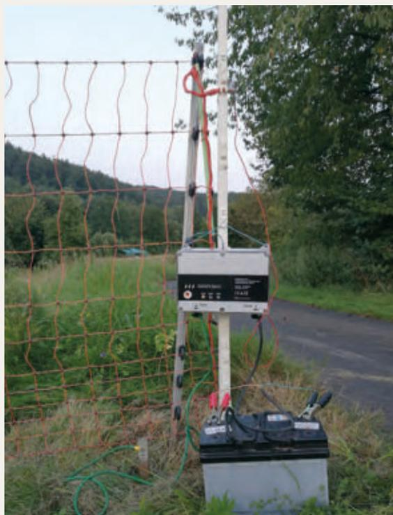
Abb. 101: Weidezaungerät mit Batterie und Erdstab
