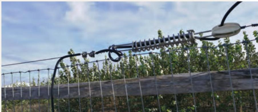
Abb. 118: Spannelement: Eine gute Hilfe, um spannungsführenden Glattdraht zu spannen
