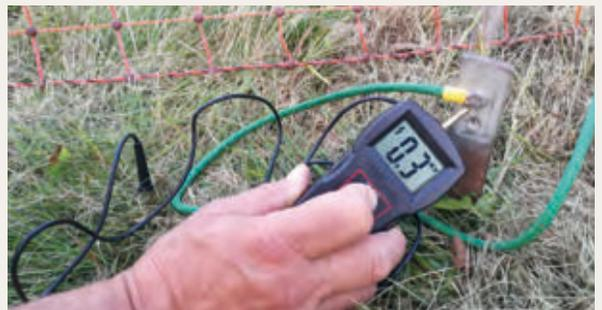
Abb. 99: Prüfen der Erdspannung (hier: 0,3  $\hat{=}$  300 Volt)
